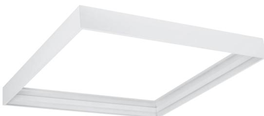
**Aufbaurahmen** | für Einlege-Backlight-Panel, Aluminium, Modul 625, weiß, Aufbauhöhe 65, Außenmaß 624 x 624, Stecksystem mit Metalleckverbindern ohne sichtbare Schrauben
